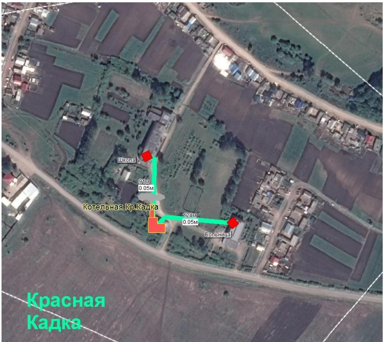
Рисунок 3-2. Схема тепловых сетей н.п. Красная Кадка
